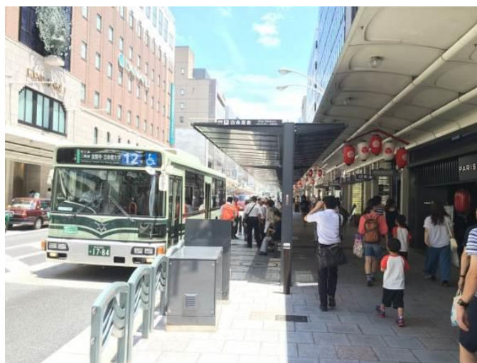
図 4-7 テラス型バス停付近の様子とT型構造のバス停上屋
